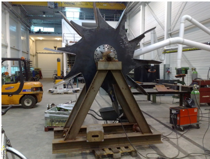
Samenstellen van een Astrumaer beluchter in onze werkplaats
